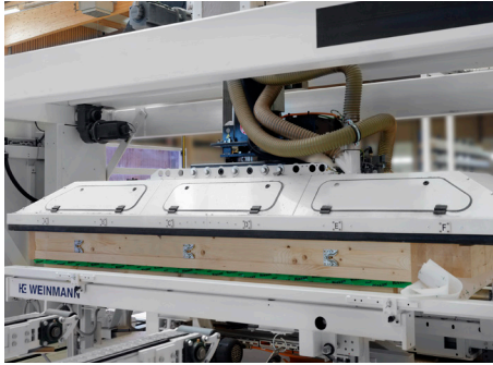
Vollautomatisches Positionieren der Einblasplatte über dem jeweiligen Gefach.
