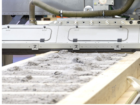
Automatische Berechnung der Füllmenge für gleichmäßige Dichteverteilung.
