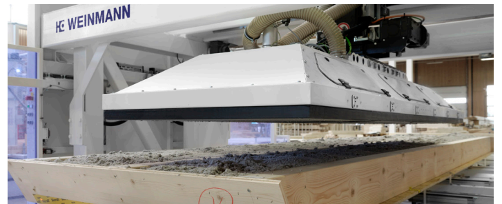
Drehbare Einblasplatte um 90° für das automatisierte Dämmen von Dach- und Deckenelementen.
