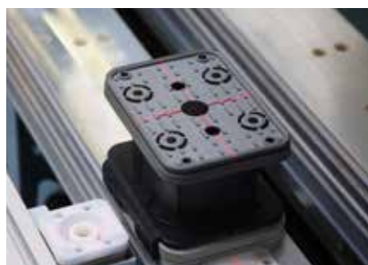
Laser pin La posizione delle ventose viene visualizzata con un raggio Laser (a croce). Come ausilio di posizionamento per pezzi sagomati è possibile far visualizzare al laser il perimetro del pezzo.
