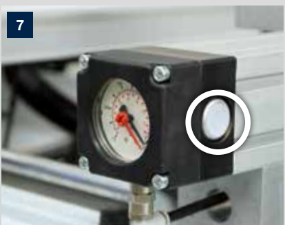
Tasto avvio di programma – Un tasto su entrambi i lati del tavolo per l'avvio della lavorazione.
