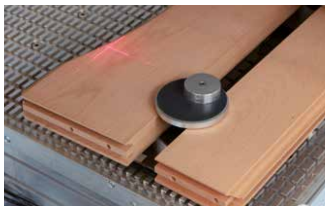
Laser di posizionamento per il posizionamento preciso delle ventose
