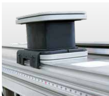
Scala millimetrica per il posizionamento delle ventose.
