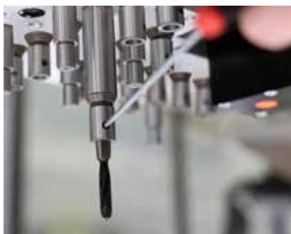
Sistema di cambio Weldon per un cambio punta con utensili
