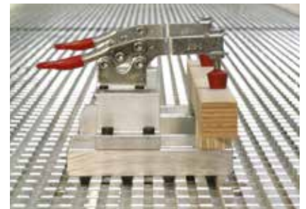
Fijación de los medios de fijación especiales: la mesa tramada de aluminio con guías de cola de milano garantiza la fijación precisa de los elementos de sujeción con arrastre de forma
