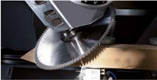
Corte especial con una gran profundidad de corte para las partes del bastidor
