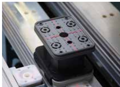
Ayuda de posicionamiento láser: las ventosas de vacío se muestran con un láser de mira en cruz. Se puede "recorrer" el contorno de la pieza como ayuda de posicionamiento de la pieza de forma libre.
