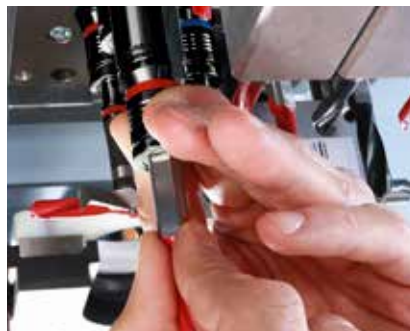
Sistema de cambio rápido patentado para un cambio de broca sin herramientas y reducción de los tiempos de preparación.
