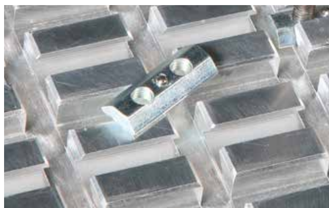
Tuercas correderas en ranura con rosca para la fijación con arrastre de forma de dispositivos de sujeción en la guía de cola de milano
