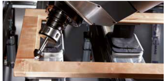
Recortes en ángulo de esquinas para los canales del cristal
