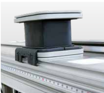
Cinta métrica para colocar las ventosas.
