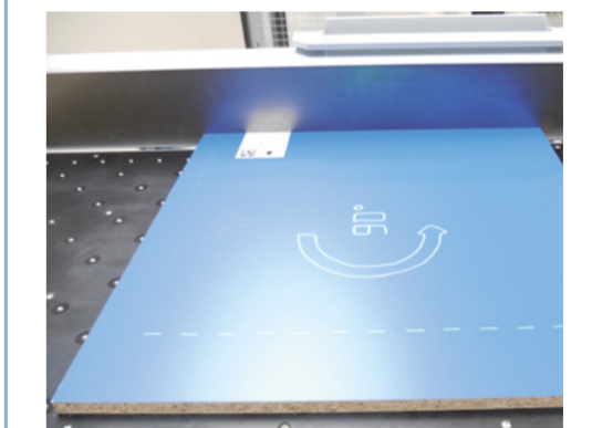
Interaction homme-machine : la scie réagit aux actions de l'opérateur
