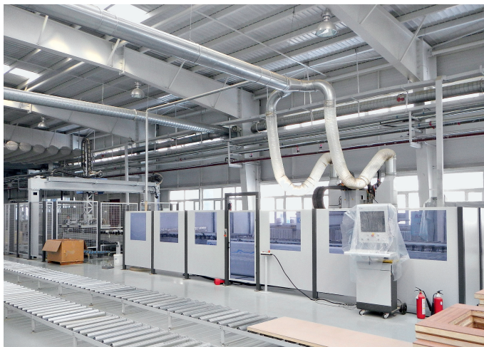
Bearbeitung der Türblattrohlinge direkt nach der Presse mit anschließender Stapelung (Fotos: Homag)
