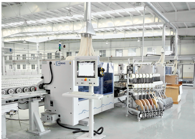
Größte Flexibili- tät bei maximaler Leistung: Einseiti- ges Falzfräsen- und -bekanten in einem Durchlauf
