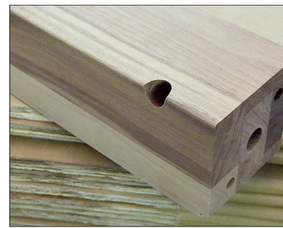
Die Homag „BMG 511“ ist für vielerlei Bearbeitungen ausgerüstet. So können Bohrungen im 45-Grad-Winkel ...
