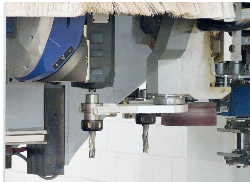
Der Werkzeugwechsler hält bei der Übergabe das neue Werkzeug schon bereit.
