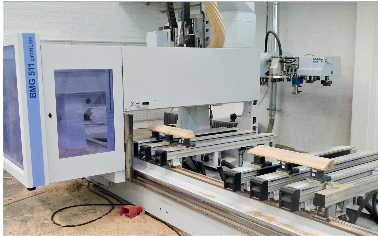
Auf den Konsolen des Arbeitstisches können während der Bearbeitung der Teile schon neue Werkstücke positioniert werden. Bei TN Tische stehen dafür insgesamt zwölf Konsolen bereit. Fotos: Krüger
