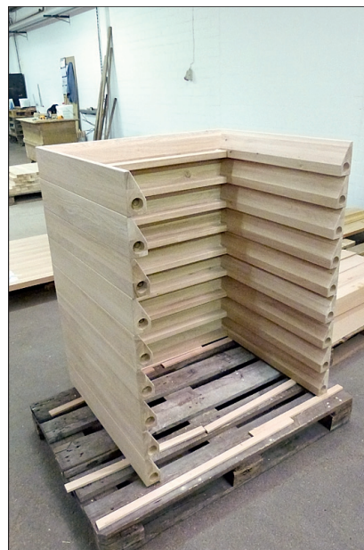
Die Tischgestelle werden nach dem CNC-Durchgang zunächst gestapelt.
